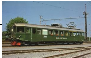
1941 Kleine Dämpfungswiderstände auf Dach
