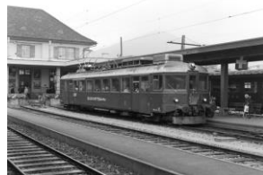
1949 Neuaufbau TW 3 und 5 ex 12 Grosse Dämpfungswiderstände plus Kasten für Regulierwiderstände über Führerstand 1
