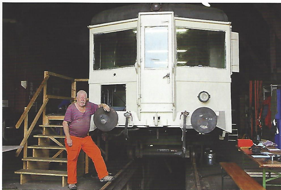
Werkstattchef Hans-Jörg Bickel koordiniert die Arbeiten. Der Wagenkasten ist weiss grundiert, er wird später wieder seine Ursprungsfarbe Grün erhalten. (Foto: Marcel Sandmeyer)
