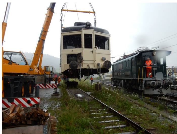
Bei strömendem Regen wird der Triebwagen mit zwei Strassenkränen angehoben. (Bild Martha Graf)
