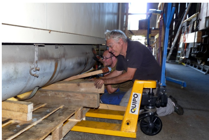
Enge Platzverhältnisse beim Ausbau des Hauptluftbehälters (Bild Hans-Jörg Bickel)
